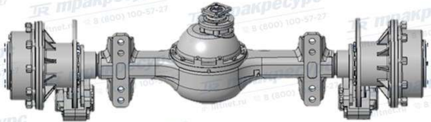
Мосты собственного производства с сухими дисковыми тормозами и открытым дифференциалом
