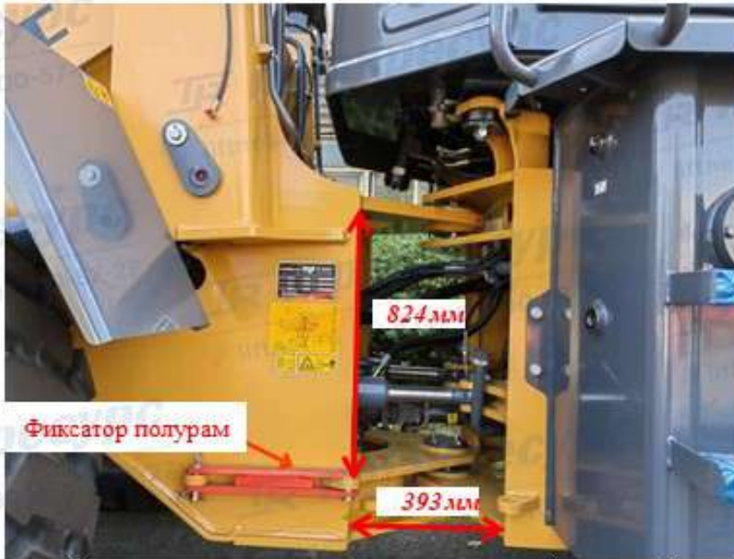
Большое расстояние между передней и задней полурамами, а также между верхним и нижним шарнирами сочленения
