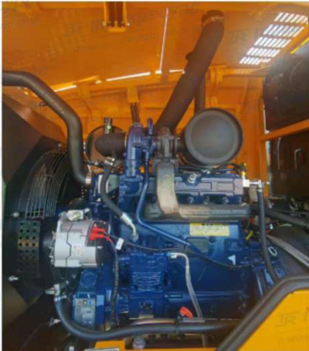
Базовым двигателем для поставок в Россию для LG833GB будет WEICHAИ WP4G100E220 мощностью 73 кВт (99,28 л.с.)
